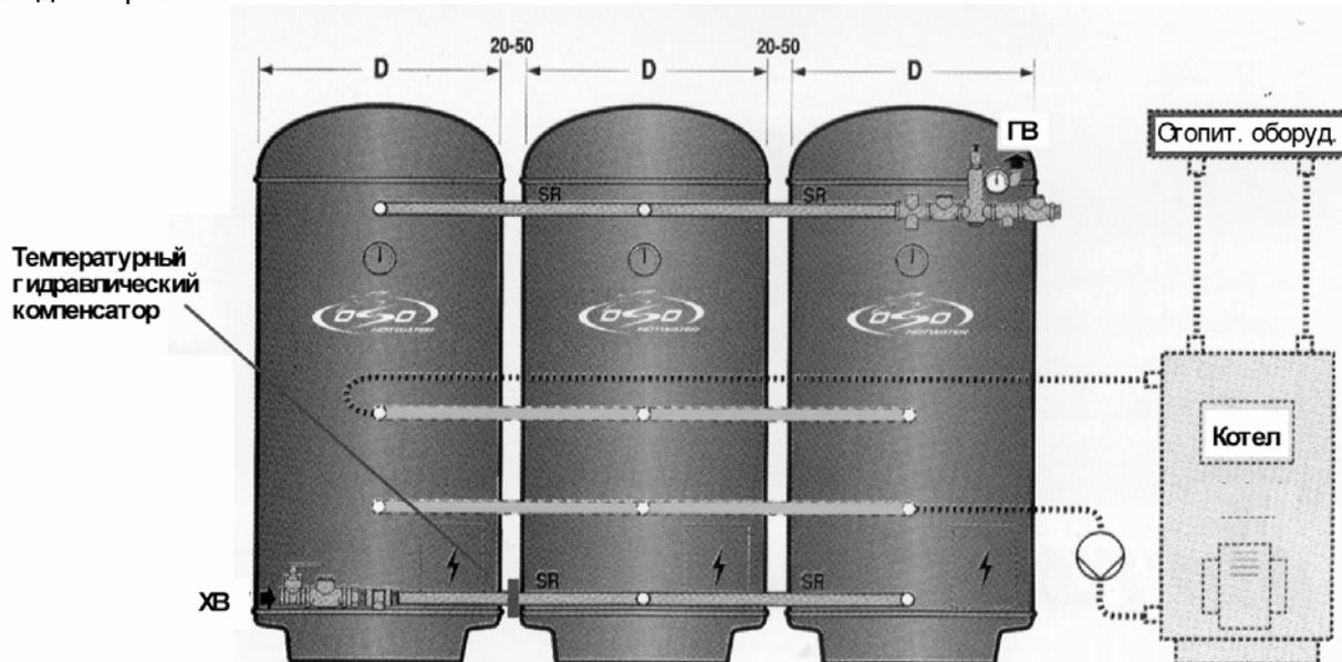
Поместите до 6 водонагревателей в линию или угол с промежутками в 5 см. Обвязка с тройниками монтируется, как показано на рисунке, на холодных и горячих патрубках, а затем скрепляется вместе. Обвязка труб должна быть теплоизолирована.
