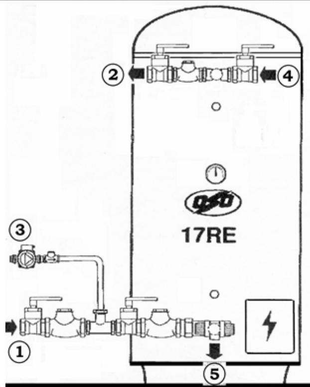
**В.** Схема подключения с циркуляцией горячей воды
