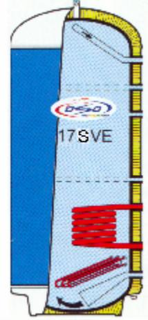
Водонагреватель со встроенным змеевиком и электрическим нагревательным элементом
