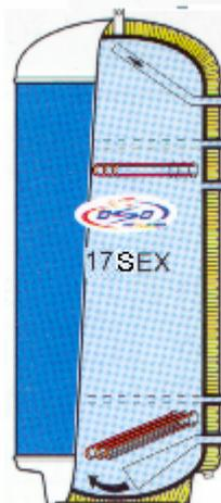
Водонагреватель с двумя группами встроенных электрических нагревательных элементов
