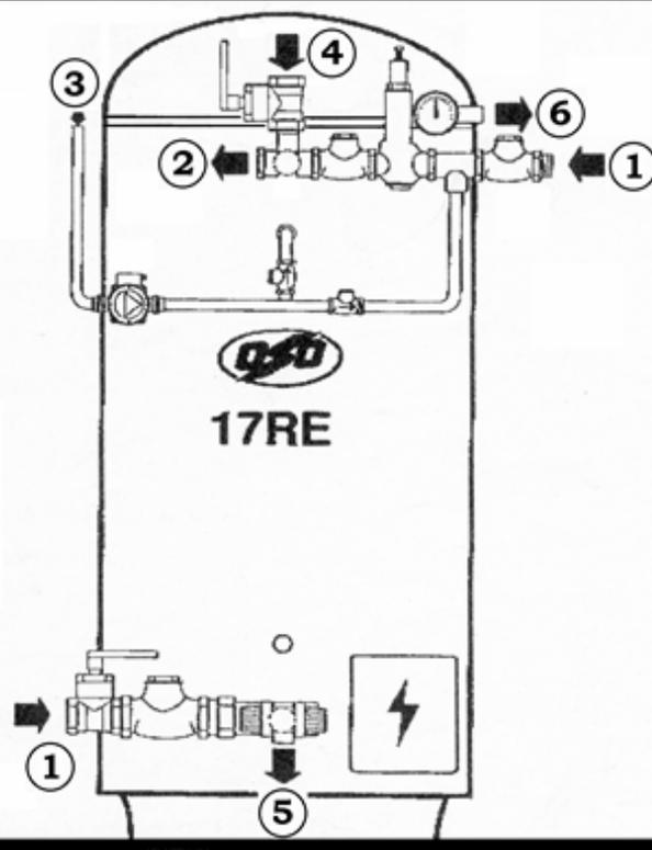
**С.** Схема подключения с термосмесительным клапаном
