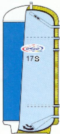
Аккумуляционный водонагреватель без встроенных нагревательных элементов
